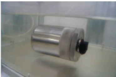
Airtightness Test การทดสอบหารอยรั่วของอากาศ
